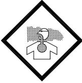
排気ガス中毒防止の為、室内、トンネル内、船倉、タンク内、テント等換気の悪い所では使用しないでください。
