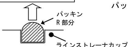
パッキン組み付け時の注意事項…パッキンには方向性があります。組み付けの際は、パッキンのR部分が、ラインストレーナ本体側になるように、組み付けて下さい。
