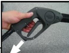
3. ガンのロックを外しトリガーを握ると吐出が始まるので、洗浄作業を開始してください。
