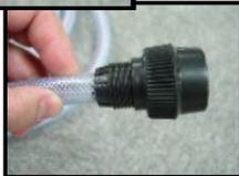
5. リングナットをしっかりと締め付け完全に固定します。
