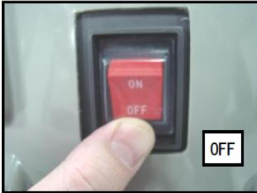
1. 電源スイッチをオフ（OFF）して、電源コードのプラグをコンセントから引き抜いてください。
