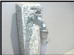
1. 供給水量が10L/min以上ある上水道を使用してください。給水ホースを蛇口に接続し、ホースをホースバンドで確実に固定してください。
