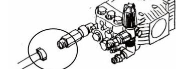
水道ホースを洗浄機の吸水口へ直接つなぐ
