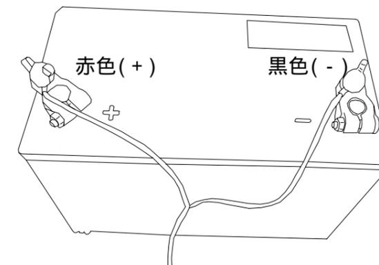
注意: バッテリー接続後のケーブルはカートの駆動部に巻き込まれないように固定してください。ケーブルが固定されていないと駆動部に巻き込まれ本機またはカートが破損する恐れがあります。
