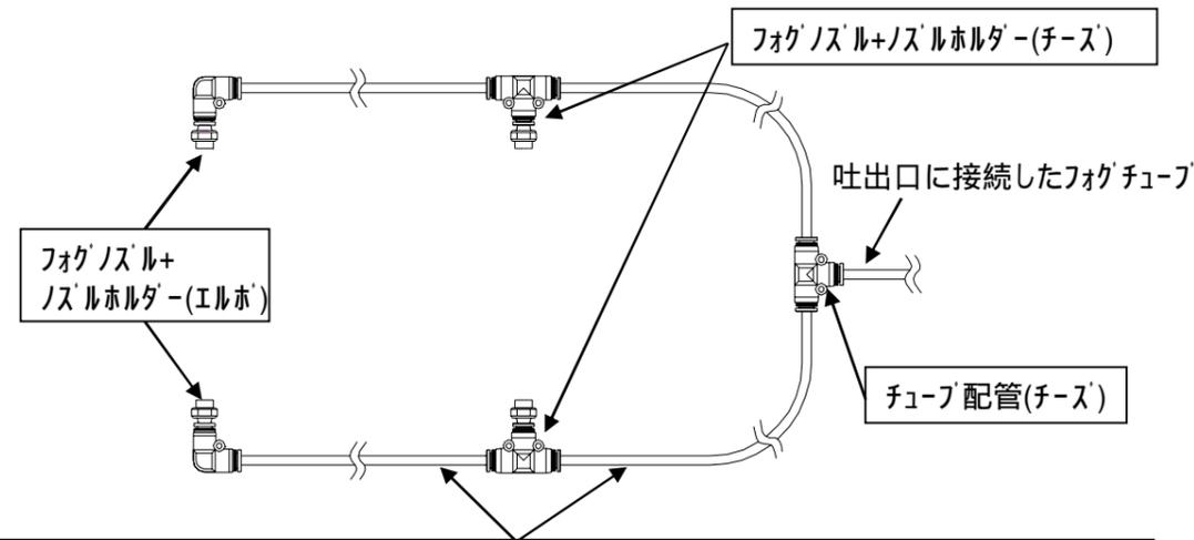
fogチューブは取付時に適切な長さにカットしてください。
