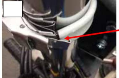
バンドのスリット開口位置を図の位置へ動かしてください。(スリット位置はハンドルを前後させて変更します。)
