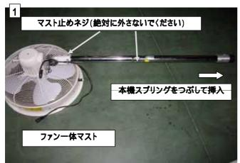
:ファン一体マストを本機に挿入します。スプリングをつぶして挿入してください。
