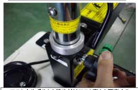
マスト止めポルトを締め付けマスト高さを固定する
