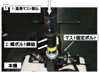
: 延長マストを溝のある方を下にし、 延長ファン取付穴(2箇所)を機体前部 の方になるよう本機に挿入してくださ い。
