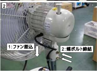
:マストにファンを取り付けます。前述 のファン取付穴に付属の蝶ボルトを2本取り付け、ファンを固定して下さい。マストには高さ調整用の穴が4箇所あります。任意の高さに調整し、マスト固定ボルトを貫通させ、締結してください。
