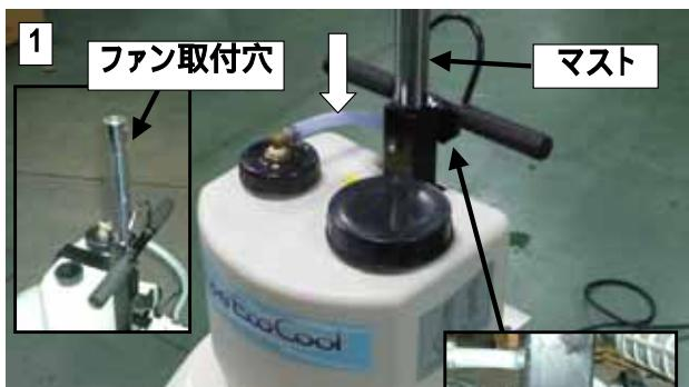
マストを溝のある方を下にし、ファン取付穴(2箇所)を機体後部の方になるよう本機に挿入してください。
