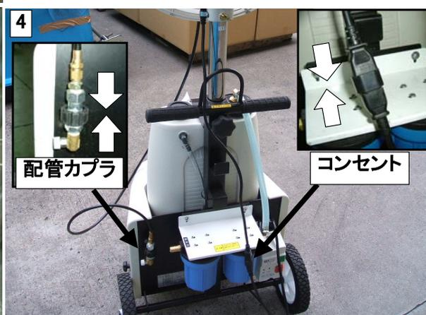
④: ファンの電源のコンセントおよび、配管のカプラをそれぞれ本機側と取り付けて下さい。
