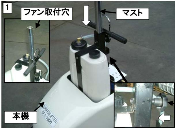
①: マストを溝のある方を下にし、ファン取付穴(2箇所)を機体後部の方になるよう本機に挿入してください。
