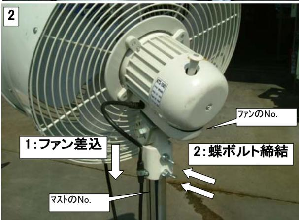
②: マストにファンを取り付けます。前述①のファン取付穴に付属の蝶ボルトを2本取り付け、ファンを固定して下さい。
